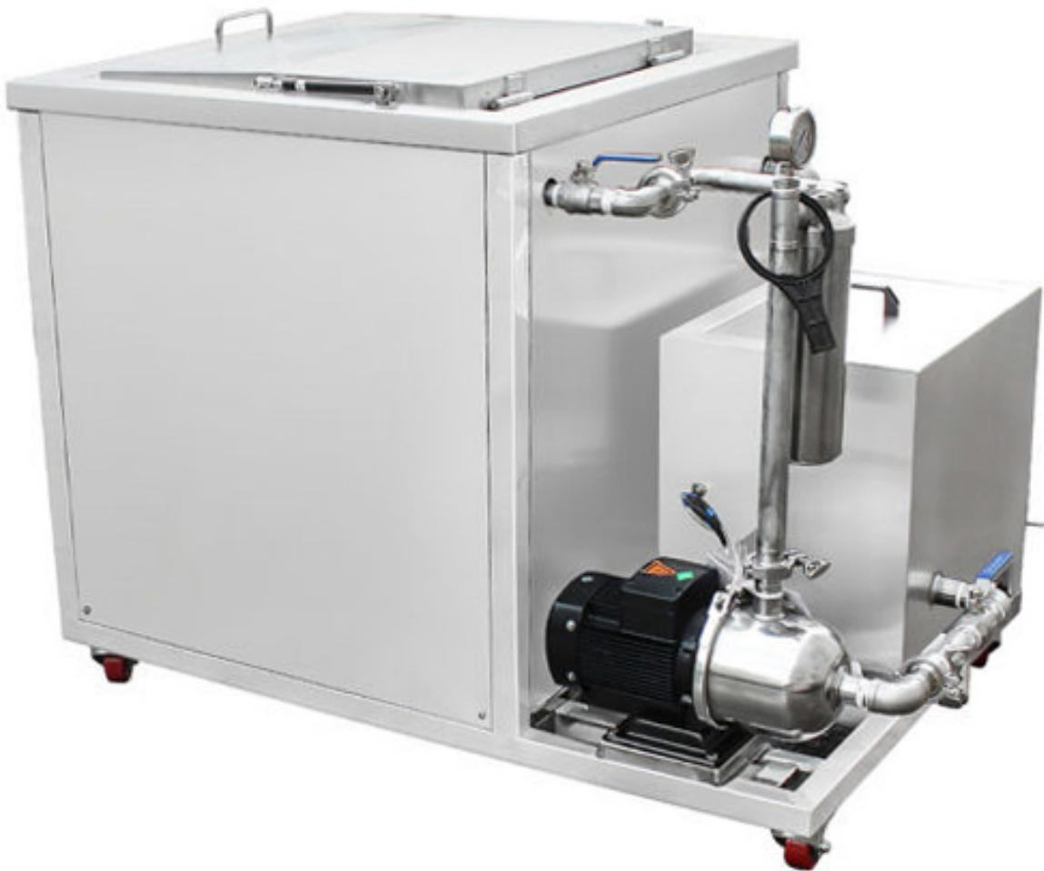
**È realizzato in acciaio inossidabile e saldato a mano con argon, garantendo una durata incredibile durante l'uso.**
