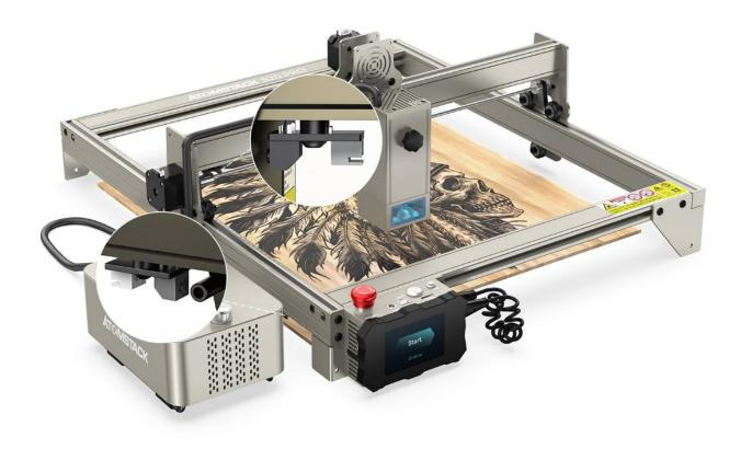
• La testata del laser è dotata di una manopola, grazie alla quale possiamo facilmente regolarne l'altezza, così come il vetro filtrante che assorbe fino al 97% della luce ultravioletta, che permette di lavorare senza la necessità di indossare occhiali protettivi.
