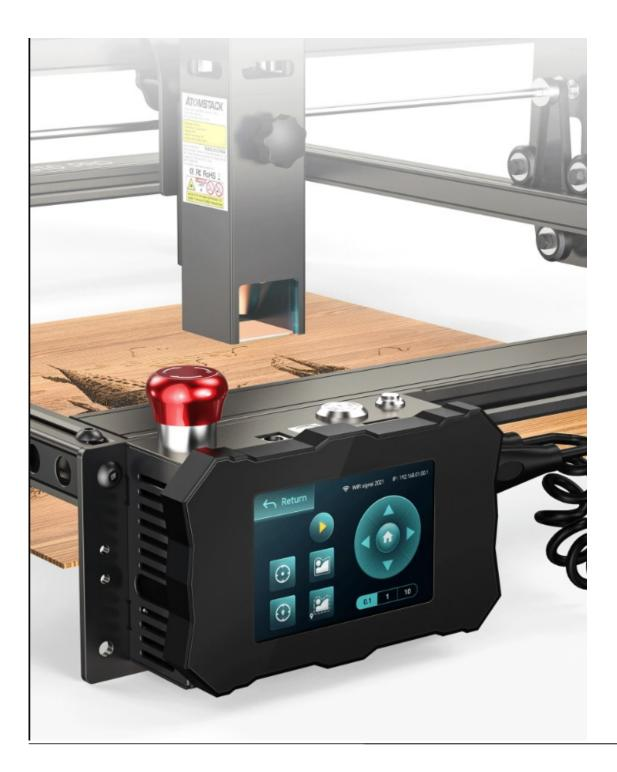
• Pannello con pulsanti e connettori utili: Possiamo fermare la macchina in qualsiasi momento utilizzando il pulsante rosso - il pulsante di sicurezza STOP, accanto abbiamo i connettori di connessione, un pulsante per accendere e spegnere rapidamente la macchina per incidere e un pulsante di RESET che ferma funziona, spegne il terminale e riavvia il dispositivo
