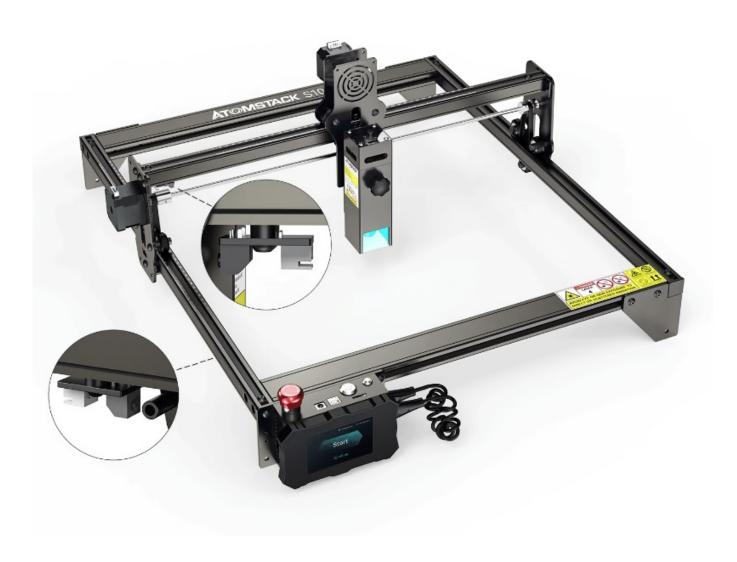
• La testata laser è dotata di una manopola, grazie alla quale possiamo regolarne facilmente l'altezza, oltre che di un vetro filtrante che assorbe fino al 97% della luce ultravioletta, che permette di lavorare senza la necessità di indossare occhiali protettivi.
