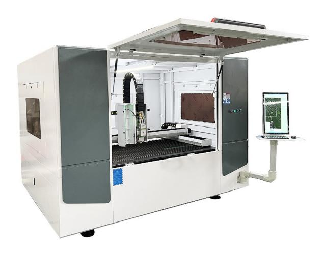
Tutti i componenti del laser sono racchiusi in un involucro chiuso, che garantisce un elevato livello di sicurezza per gli operatori e pulizia sul posto di lavoro.
