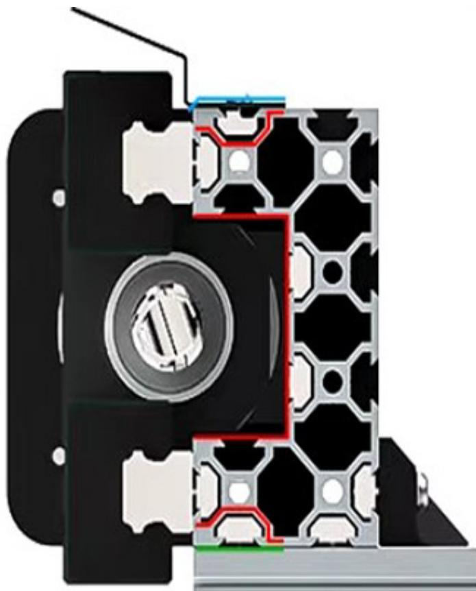
I fori di montaggio nei profili sono ravvicinati per bloccare i trucioli di taglio e rinforzare le scanalature di montaggio sulla guida.
