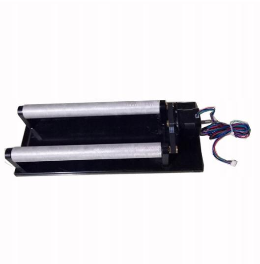
È un accessorio di alta qualità per forme regolari, ad esempio bottiglie, bicchieri e tutti gli oggetti ovali. 2 maniglie a rullo Regolazione impugnatura: 2-70 mm È possibile installare l'adattatore in qualsiasi tipo di plotter CO2.
